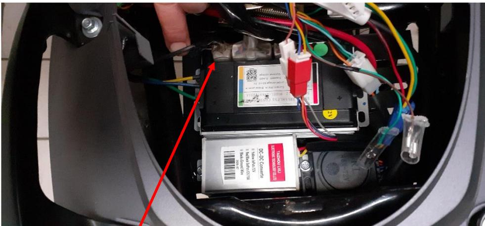
Couper les colliers qui tiennent le câble moteur le long du bras oscillant, et débrancher le connecteur des capteurs moteur
