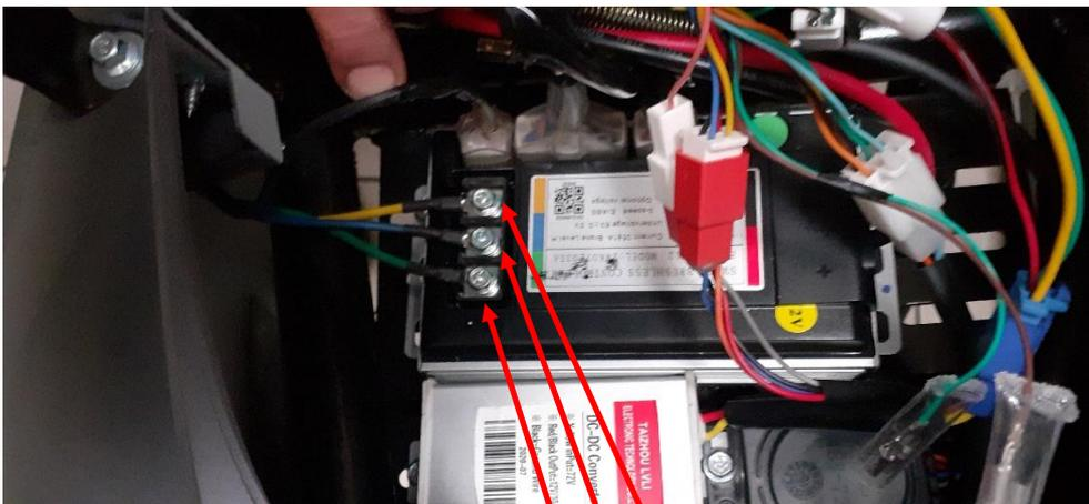
Débrancher les 3 phases moteur
